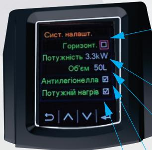
При установці водонагрівача горизонтально обов'язково встановіть галочку в цьому пункті для відображення меню в горизонтальному вигляді.
